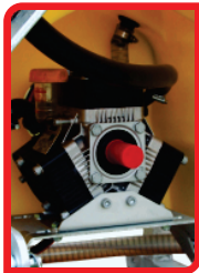
Bomba tipo diafragma de 3 membranas de económico y fácil mantenimiento.
