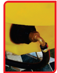
Agitador hidráulico para mejor homogenización de la mezcla.
